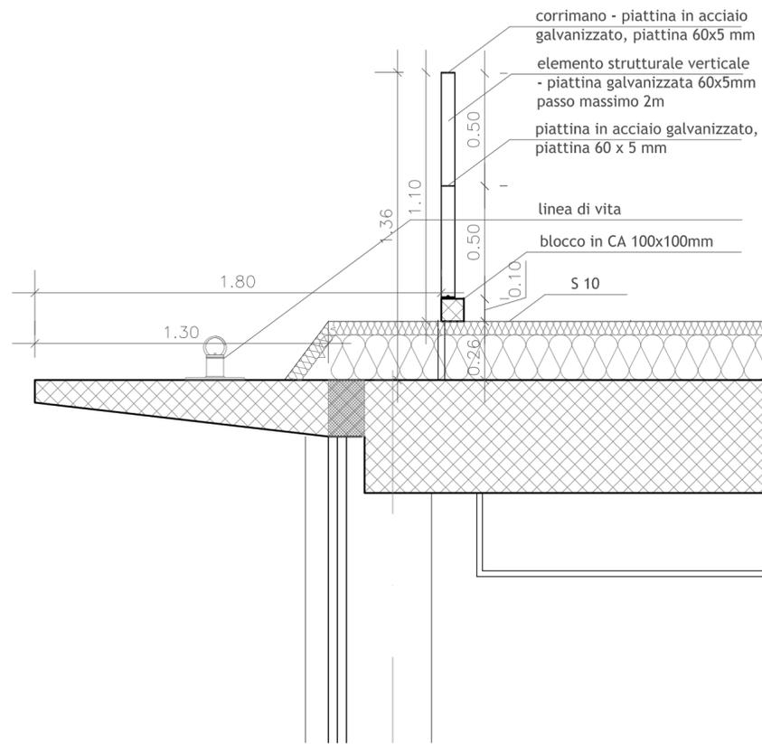
P.C. Parapetto Copertura - Dettaglio Sezione 1:20
