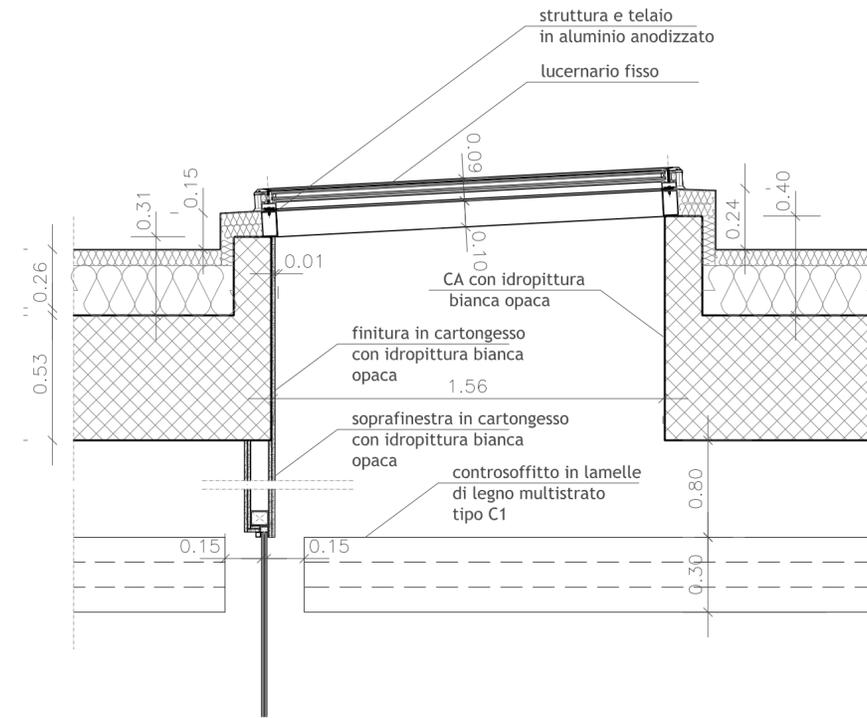
L.C. Parapetto Copertura - Dettaglio Sezione 1:20
