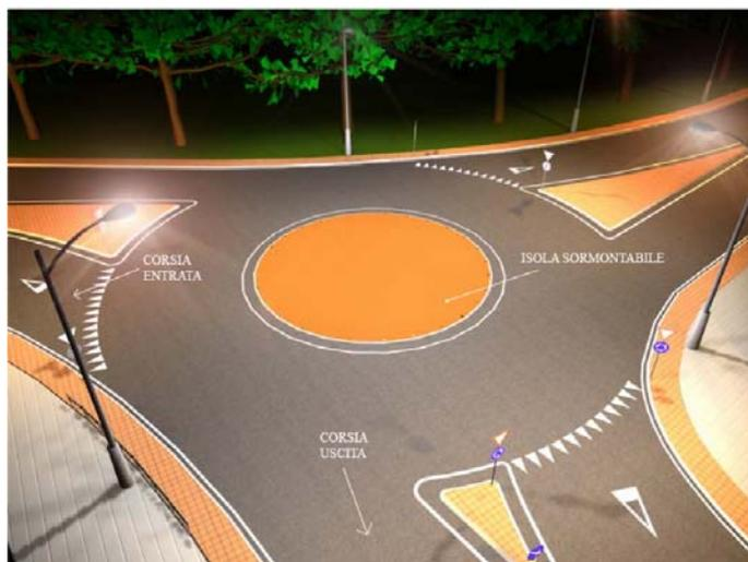
In area urbana vengono generalmente progettate rotatorie con raggio esterno massimo di 12m, con isola centrale sormontabile.
