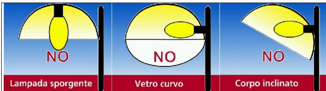
Figura 5.1 – Tipologie di apparecchi non ammessi
