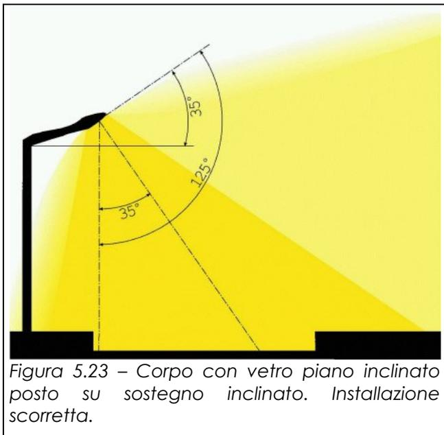
La situazione peggiora ulteriormente, figura 5.23, quando anche il sostegno o lo stesso corpo illuminante è inclinato. In tale situazione l'inclinazione del vetro piano si somma a quella del sostegno per incrementare l'angolo globale ed ovviamente la dispersione di luce verso il cielo.
