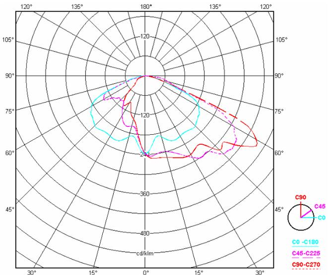
Figura 5.15 - Curva fotometrica di apparecchio asimmetrico misurata su 3 piani.
