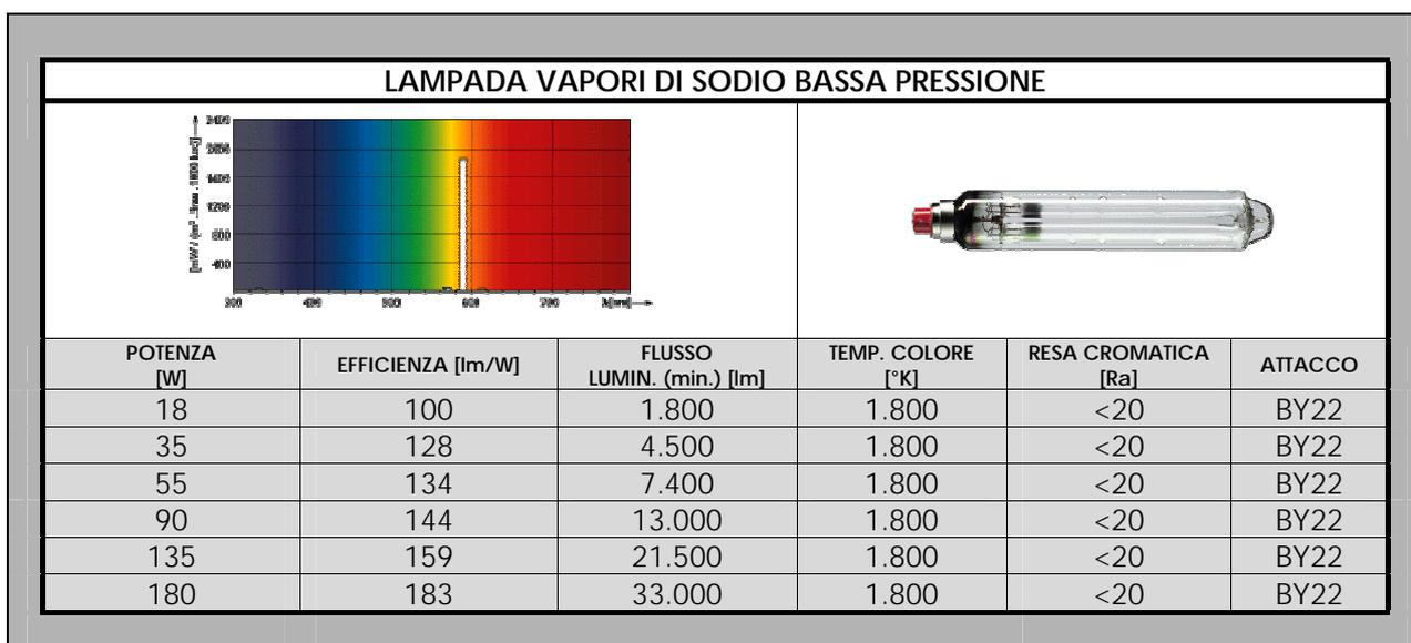
Figura 5.9 – Caratteristiche principali di alcune tipologie di Lampade al sodio bassa pressione
