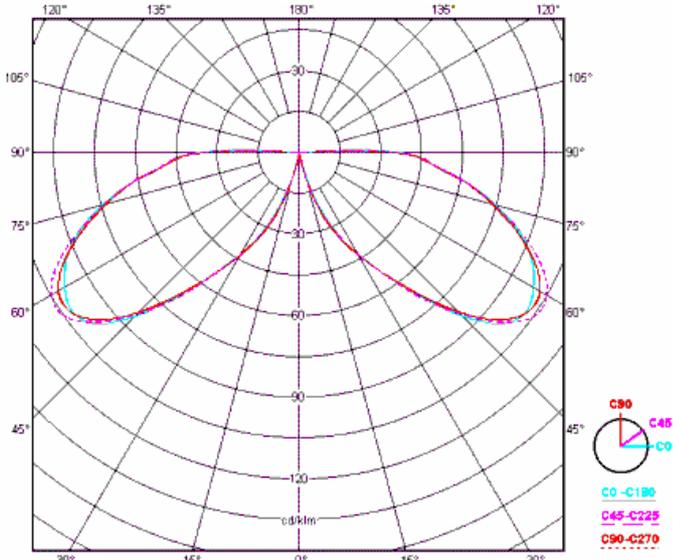
Figura 5.13 - Curva fotometrica simmetrica (le misure su i tre piani sono quasi identiche)
