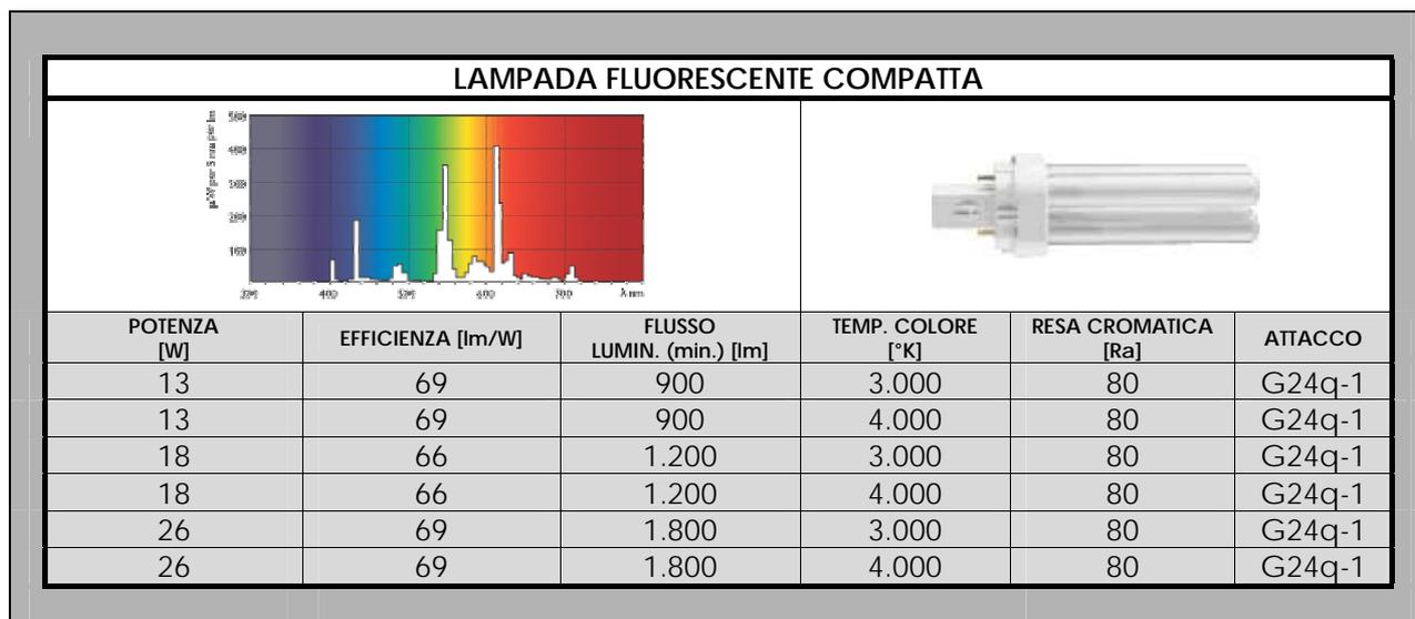
Figura 5.10 – Caratteristiche principali di alcune tipologie di Lampade fluorescenti compatte
