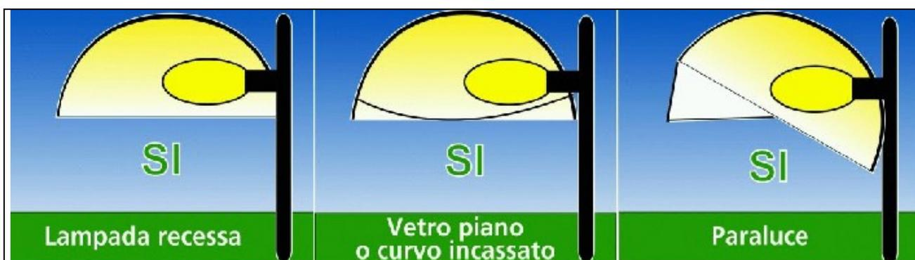
Figura 5.2 – Tipologie di apparecchi conformi alla legge n.17/2000
