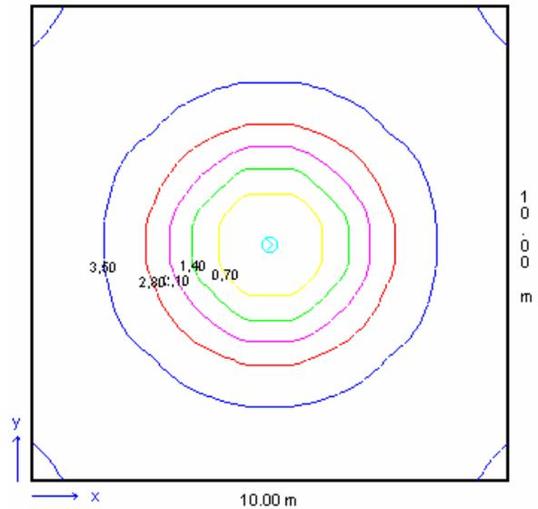
Figura 5.14 - Illuminamento con curve isolux rotonde e concentriche.
