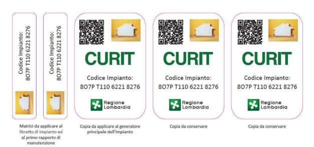
Sarà applicata un'unica targa anche nel caso di impianto costituito da uno o più generatori di calore, anche se di tipo diverso, ma che condividono il medesimo apparato di distribuzione (il sistema di tubi che porta l'acqua o l'aria riscaldate ai termosifoni o ai pannelli radianti a pavimento oppure agli split o ai fancoil), poiché lo si considera un unico impianto termico.
