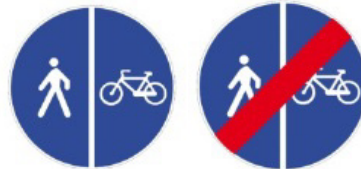
PISTA CICLABILE CONTIGUA AL MARCIAPIEDE
