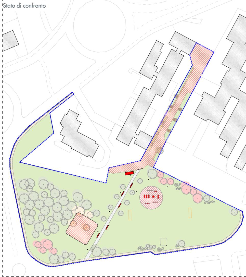
Tensostruttura per eventi con pavimentazione in ghiaia. Dimensionamento della struttura in 250mq per ospitare più di 200 persone per eventi seduti e oltre 400 per eventi in piedi.
