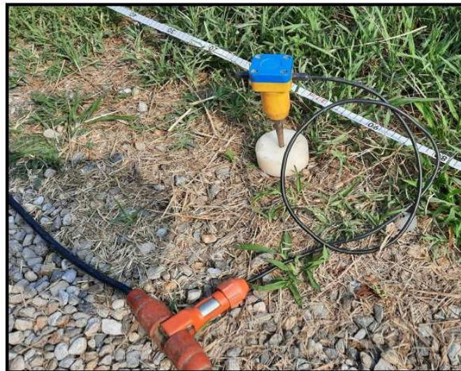
Figura 2: Geofono da 4.5 Hz e cavo sismico.
