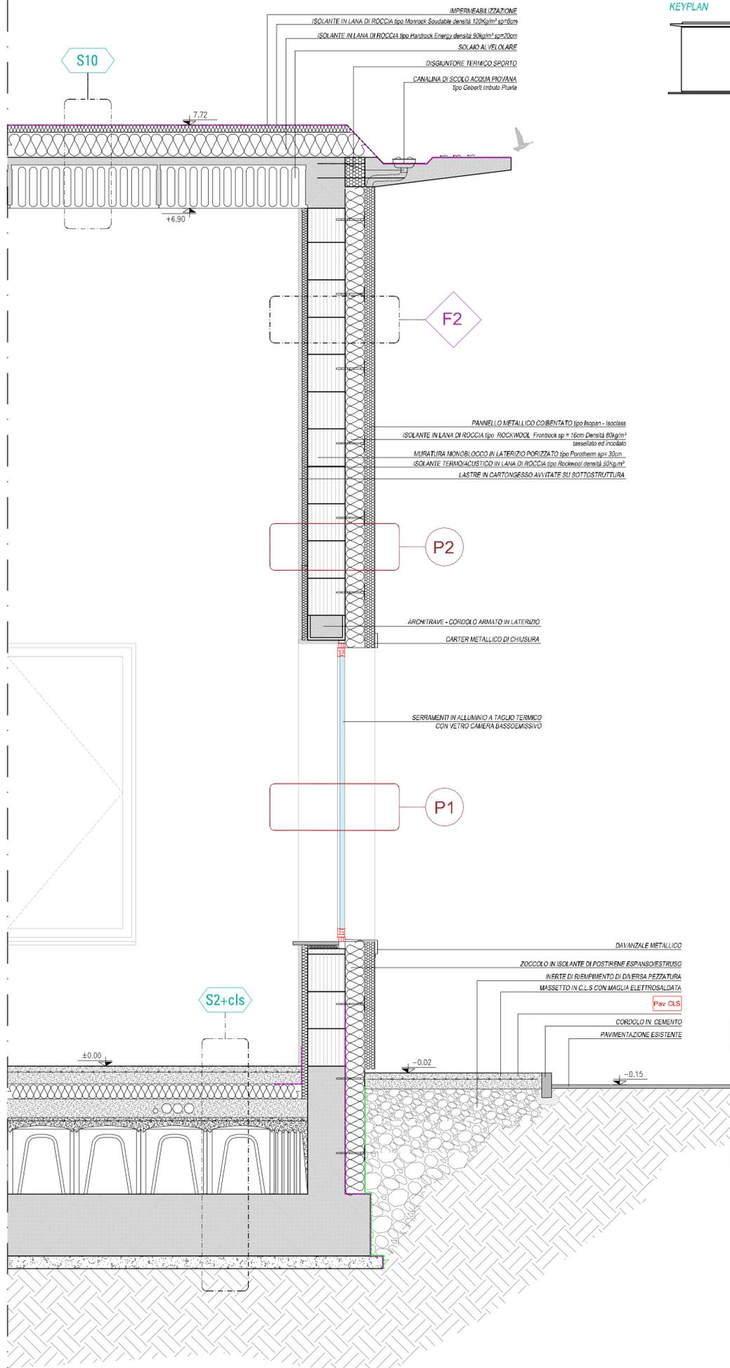
SEZIONE TRASVERSALE ATTACCO SERRAMENTO SU MURATURA IN LATERIZIO PORIZZATO SCALA 1:10
