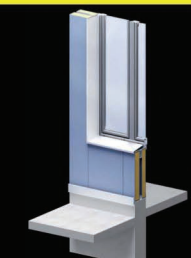
SPACCATO ASSONOMETRICO DELL'INVOLUCRO
