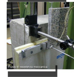
Stratificazione dell'involucro "sandwich" + elemento industrializzato per facciata ventilata.
