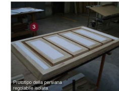
Prototipo della persiana regolabile isolata.
